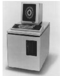
**1980** : **Onyx** présente son ordinateur **Onyx C 8002** équipé d'un processeur Z8000, de 256 Ko de Ram, d'un disque dur, d'un lecteur de bandes, de 8 ports série et tournant sous **Unix** pouvant accueillir 8 utilisateurs pour 20000 \$. Il s'agit du premier micro ordinateur tournant sous Unix.
