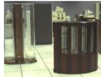
L'unité centrale (sur la droite) est entièrement immergée dans un liquide conducteur de chaleur et isolant électrique (fluorinert) pour assurer son refroidissement. Les colonnes transparentes visibles à gauche servent à évacuer les bulles se formant dans le liquide entrant partiellement à ébullition au contact des circuits de l'unité centrale.
